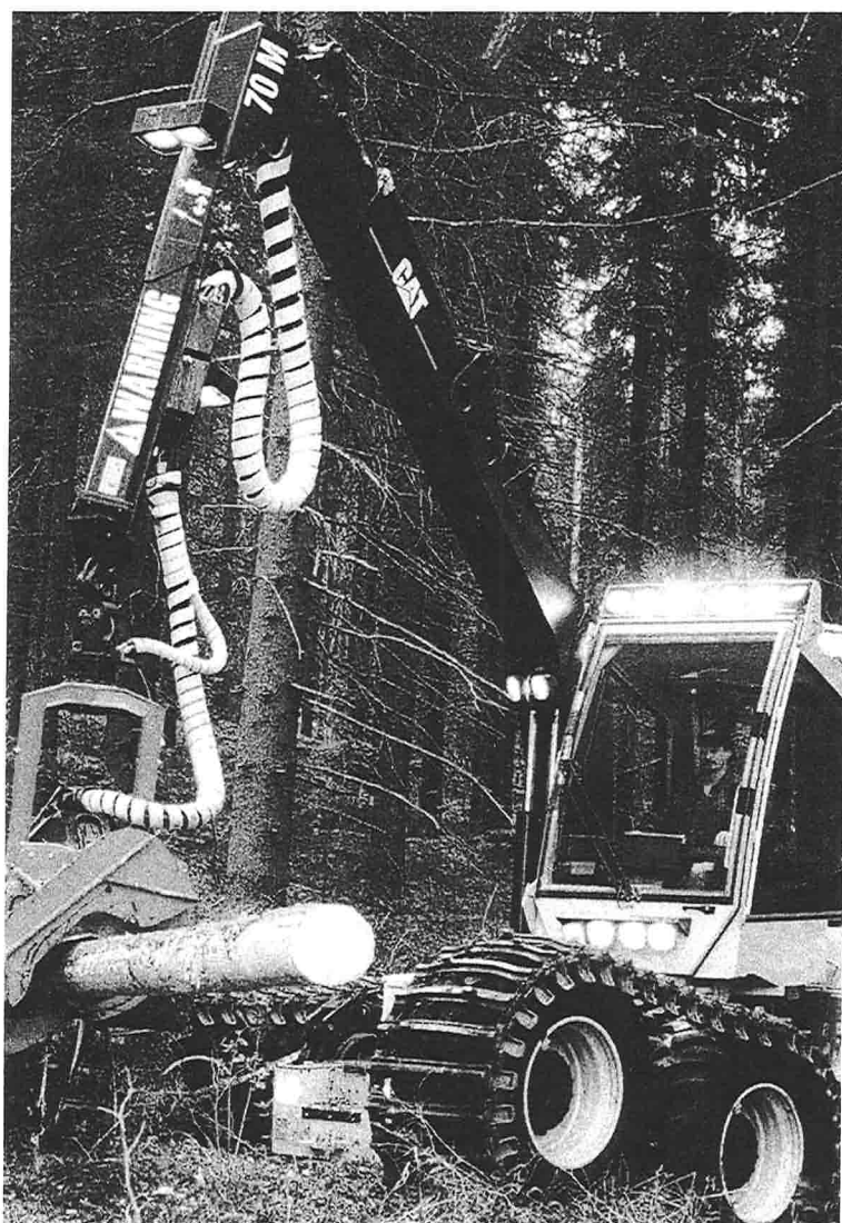
Einsatz Vollernter: Fällen, entasten, vorliefern an Rückegasse, sortieren
